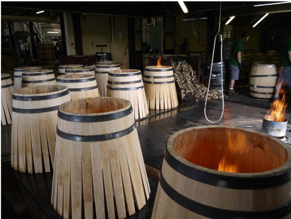
Les **braseros** sont visibles (ils chauffent les douelles assemblées en rose pour faciliter le cintrage, puis le cerclage) : deux d'entre eux se situent au centre de la photographie. Les autres braseros se devinent par les flammes sortant des tonneaux. Au fond, on aperçoit les cercles et aussi les chutes de bois qui servent à alimenter les chaufferettes (photo R.-P. DUBRION).
